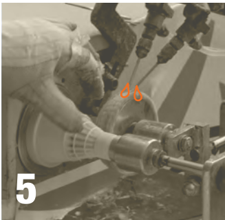
5 Klebmaschine zum Fixieren des Doppelgarns. Gluing machine to fix the double-yam.
