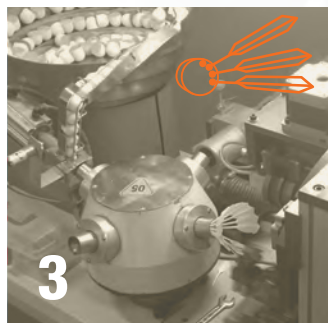
Federn werden maschinell in den Kork eingesetzt. Feathers are mechanically inserted into the cork.
